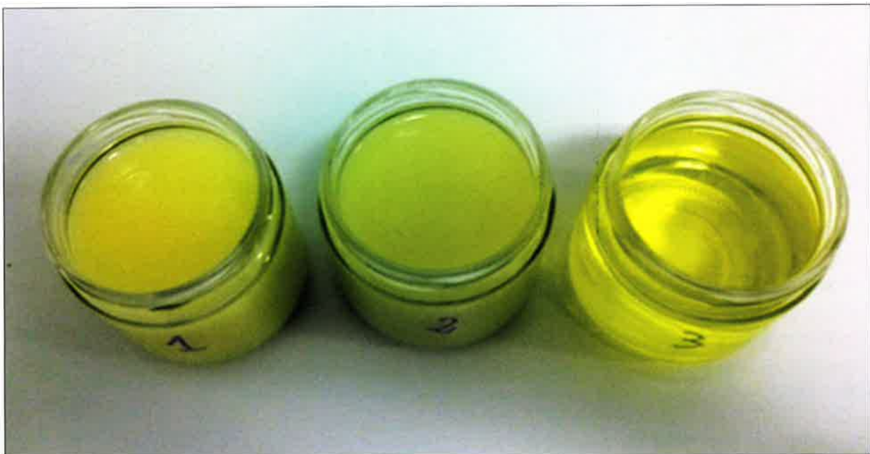
Fig. 5. Lactosuero concentrado por OI (1), Concentrado por UF (2), Permeado por UF (3).
