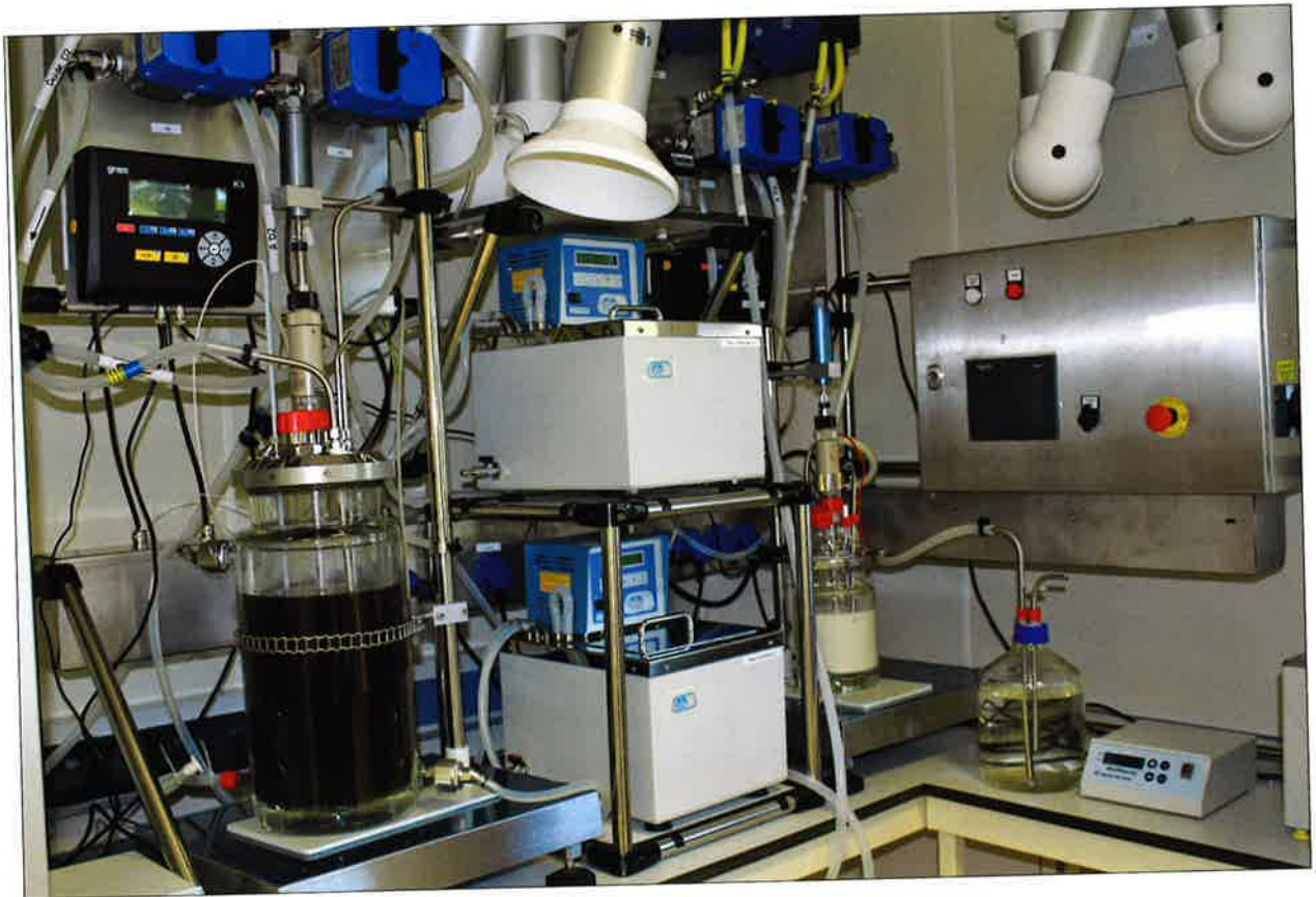
Fig. 6. Planta de biogás de doble etapa (AZTI).
